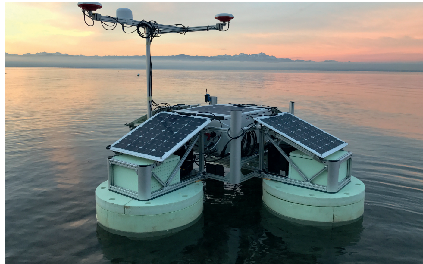
Bild 5 Vermessung der Sedimentmächtigkeit und Sedimentstruktur mit dem autonom operierenden Messfahrzeug „Hydrocrawler“
